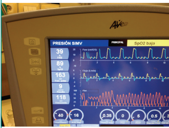
Figura 2. Pantalla (módulo de interfaz del usuario) con botones de membrana e indicadores de LED
