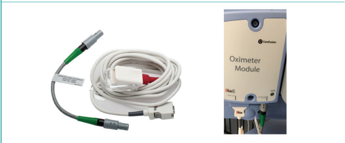
Figura 1. Cable paciente, cable interfaz y módulo de oxímetro
